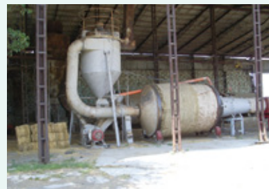
ペレット製造設備。原料乾燥設備(写真: JICA)
