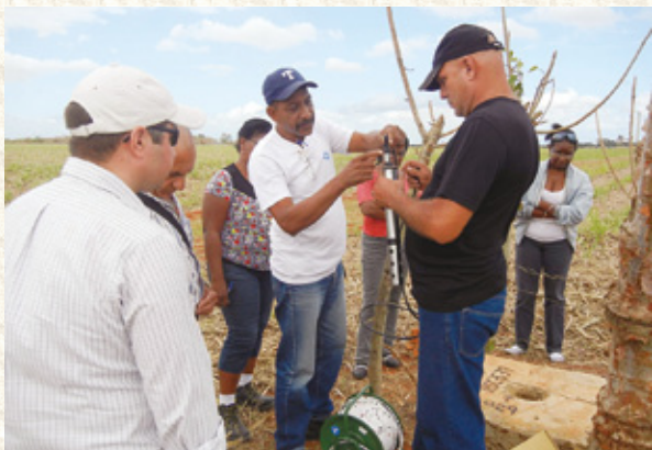
多項目水質計を使用した観測井戸深度別水質測定方法の研修を受ける水利公社の技術者（写真：宇田川 弘勝）
