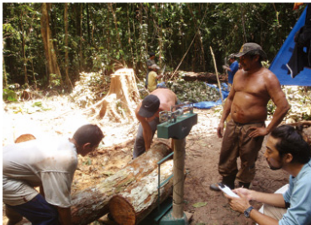
アマゾン川上流の調査地で、20メートル四方にあるすべての木の重さを測り、炭素数を推定する「地上班」(写真:JICA)
