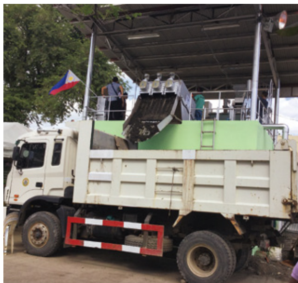
市内で発生した全ての浄化槽汚泥をアムコン株式会社が開発した脱水機で処理し、トラックで移送するところ。水分は適切な処理をして川に放流、固形分は堆肥化が可能(写真:アムコン(株))
