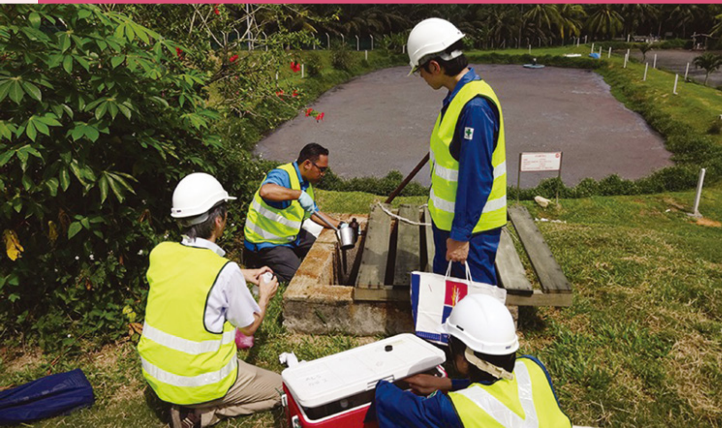
マレーシアで、パームオイル工場における既存の水処理用ラグーン池から水質調査のために採水している阪神動力機械チーム
